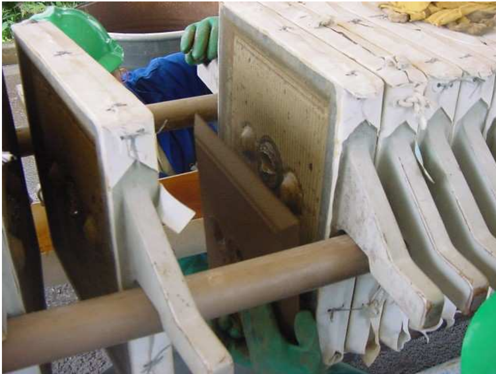
Detalhe da retirada da placa de lodo do filtro prensa
